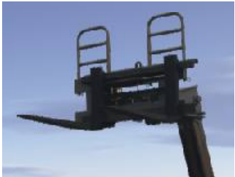
Forche con traslatore idraulico Forks with hydraulic side-shift
